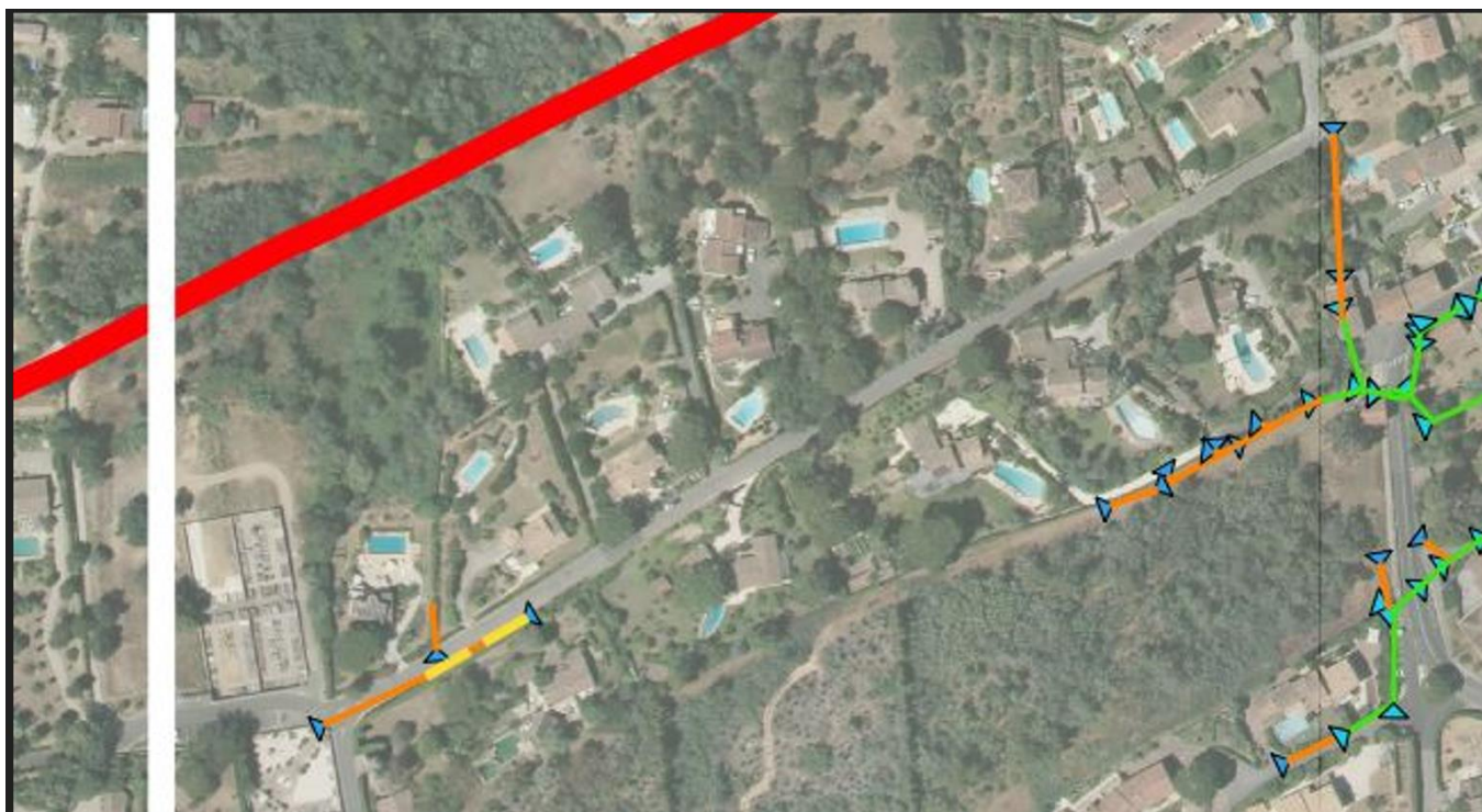
Plan du réseau d'eaux pluviales
